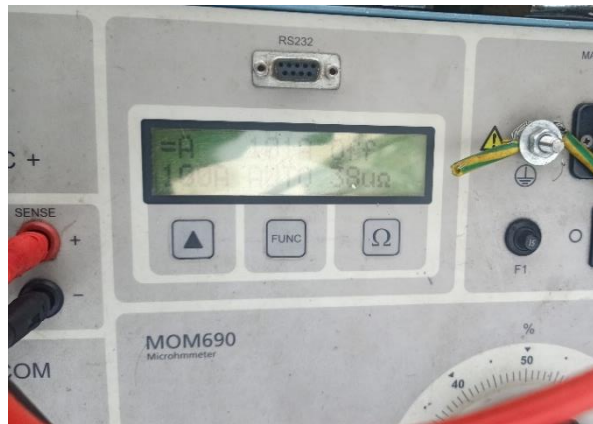
Gambar 4. Hasil tahanan kontak pada PMT fasa R.
