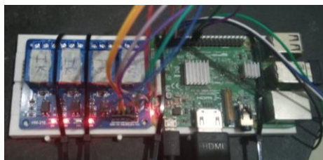
Gambar 9. Relay 4 Menyala kemudian Mati Selama 0.2 detik dengan 2x.
