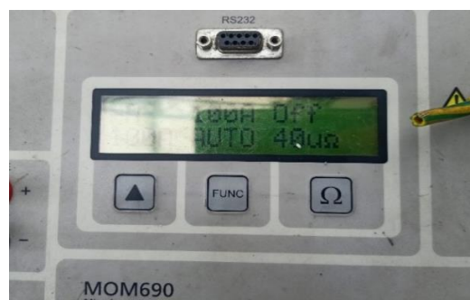
Gambar 8. Hasil pengukuran tahanan kontak pada PMT fasa T
