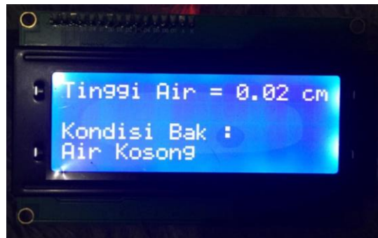
Gambar 9. Hasil pengujian dengan keadaan bak penampungan air kosong.
