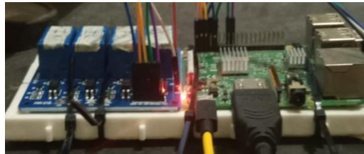
Gambar 11. Relay 1 dan Relay 2 Mati saat Menerima Perintah “matikan motor”, Disertai Relay 4 Menyala Selama 0.2 Detik Kemudian Mati.
