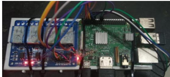
Gambar 5. Relay 1 dan Relay 2 Menyala saat Menerima Perintah “Halo motor”.
