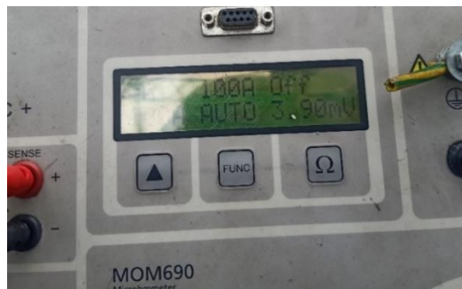
Gambar 7. Hasil pengukuran tegangan pada PMT fasa S
