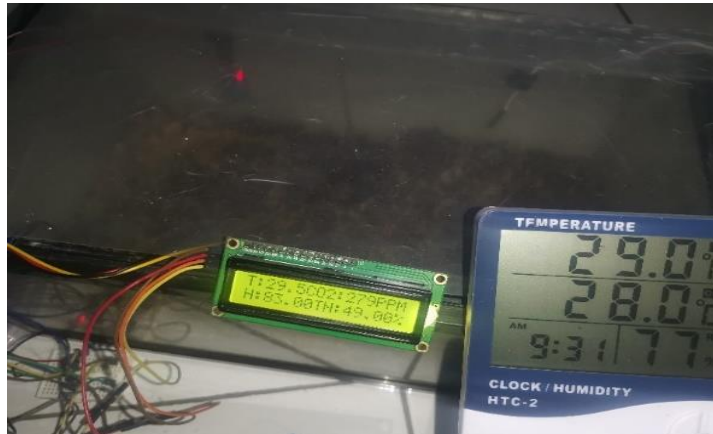
Gambar 8 Tampilan kalibrasi sensor DHT11 dengan HTC-2
