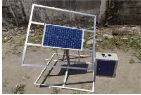
Gambar 6. Solar Tracker 2 axis dengan pemberat air yang telah dibuat.
