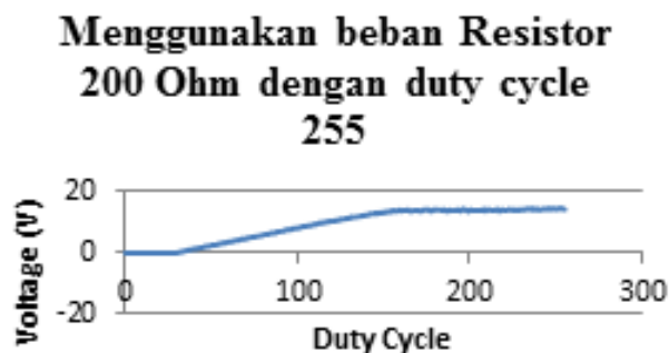
Gambar 3. Grafik pengujian algoritma menggunakan beban resistor 200 Ohm
