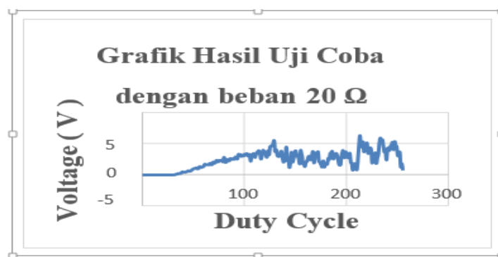
Gambar 5. Pengujian Maximum Power Point Tracking dengan beban 20 Ohm
