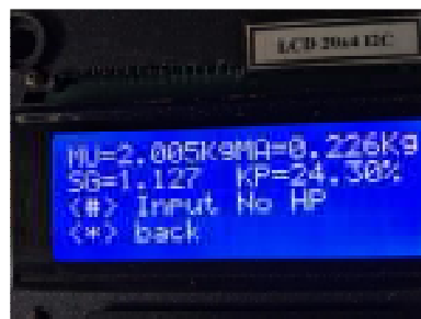
Gambar 4. Tampilan Hasil Pengukuran Kadar Pati Ubi pada LCD
