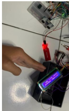
Gambar 10. Kondisi Alat Peraga untuk mengukur ketinggian Air
