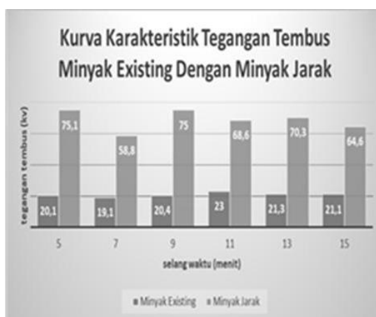
Gambar 4. Kurva karakteristik tegangan tembus minyak
