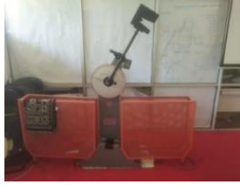
Gambar 3. Alat uji impact jb 300 b
