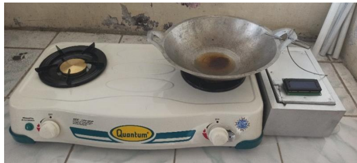
Gambar 4. Konstruksi sistem stabilisasi dan kontrol suhu penggorengan.
