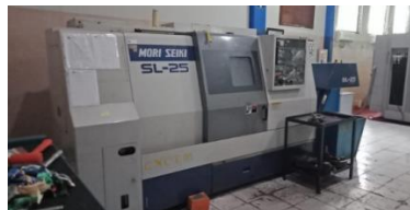
Gambar 3. CNC Bubut MORI SEIKI SL-25B/500
