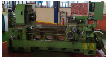
Gambar 2. Mesin Bubut Tornos Geminis S.L.
