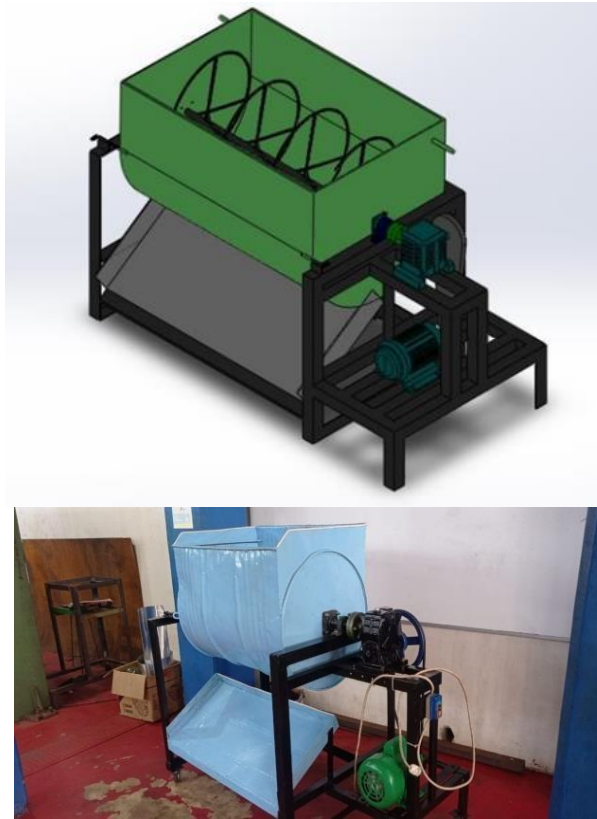
Gambar 2. Mesin Pengaduk pakan Sapi Kapasitas 50 kg/5menit
