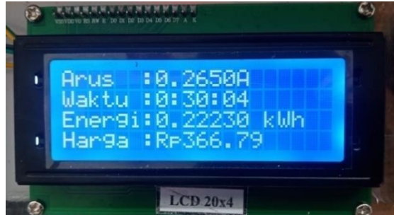
Gambar 2. Tampilan LCD pengisian baterai dengan tambahan beban 25Ω
