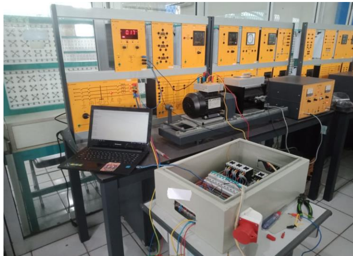
Gambar 1. Proses Pengujian Terhadap Motor Slip Ring 3 Phase
