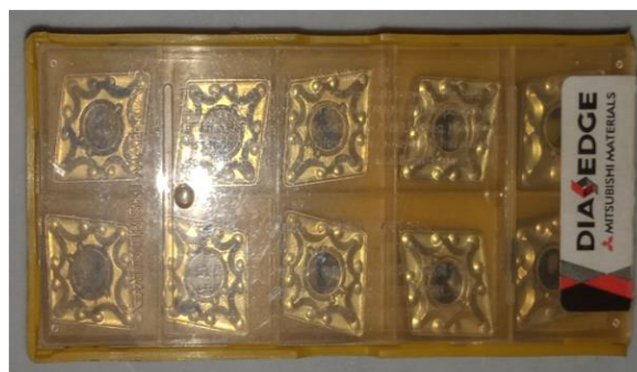
Gambar 2. Mata potong insert carbide CNMG 120408
