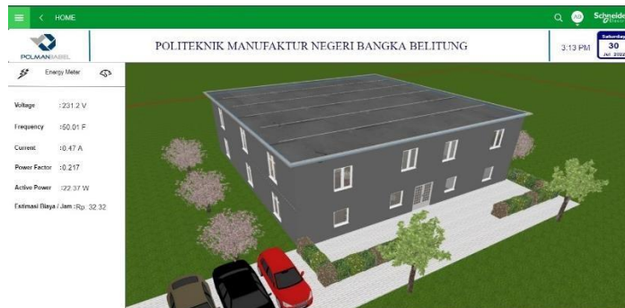
Gambar 5. Tampilan Data Energy Meter pada HMI
