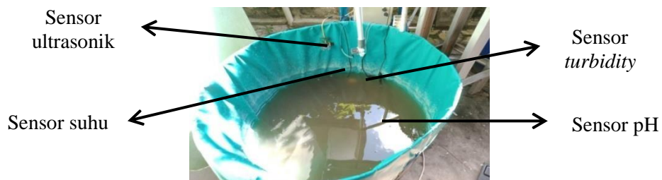
Gambar 3. Hardware non-elektrik sistem kontrol
