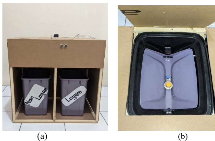
Gambar 6. Tampilan tempat sampah (a) Hasil alat bagian depan (b) Sensor dan pemilah sampah dalam keadaan tidak mendeteksi objek sampah
