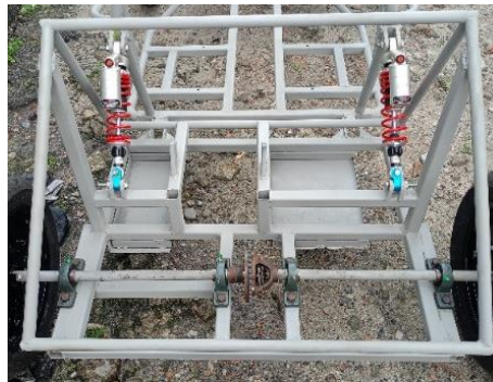
Gambar 2. Hasil Pembuatan Rangka Bagian Belakang
