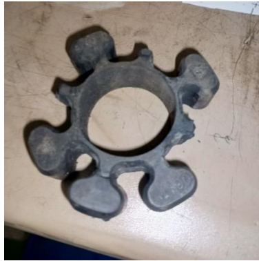
Gambar 2. Karet Coupling yang Rusak
