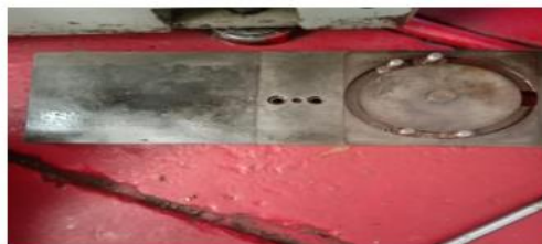
Gambar 4.4 Proses Perbaikan Eretan melintang
