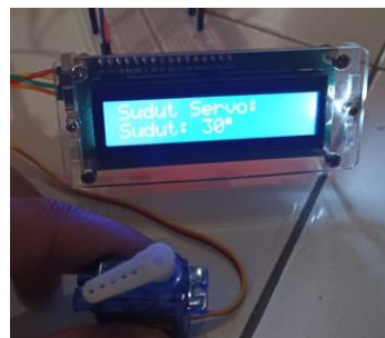
Gambar 8. Pengujian Motor Servo
