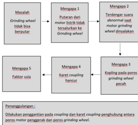
Gambar 1. Analisa Kerusakan Pada Grinding Wheel
