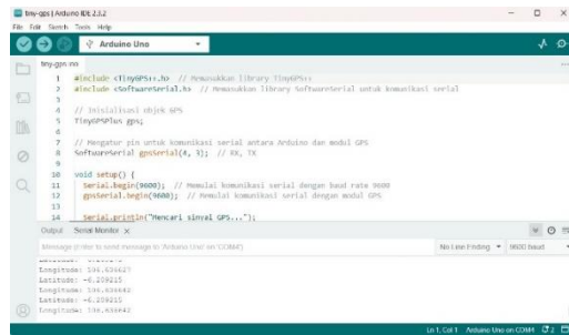
Gambar 4. Program Modul GPS NEO-6M V2
